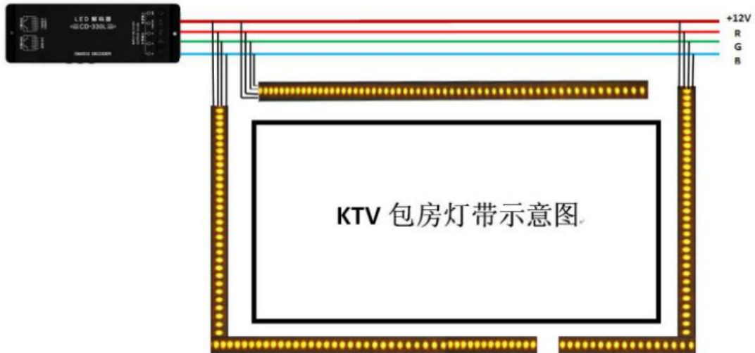
图 6 KTV 包房解码器接线示意图
