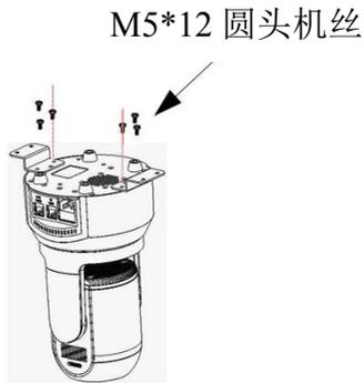
2、天花板与产品安装：①在灯具安装处使用木板加固处理。②根据需要在天花上开出线孔。③将天花开孔处穿出的网线及电源线插入产品对应接口。④调整产品安装方向后将产品固定到天花板上。如图示；
