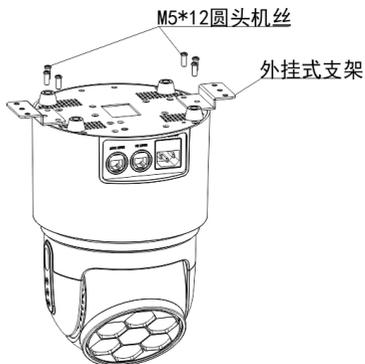
2、天花板与产品安装：①在灯具安装处使用木板加固处理。②根据需要在天花上开出线孔。③将天花开孔处穿出的网线及电源线插入产品对应接口。④调整好产品安装方向后，将产品固定到天花板上。如图所示；
