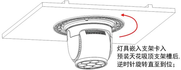
5、将天花吸盘上的弹簧扣向内压，然后将天花吸盘卡入灯具底座与预装天花支架之间的间隙，如图所示；
